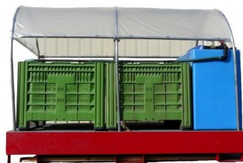
Abb. 1: Biobac®-Anlage der Fa. CCD SA mit zwei Behandlungs-Containern à 550 Liter (Masse: 1.2m X 1m) inklusive automatischer Bewässerungsanlage sowie einem Regendach. Foto: CCD SA
