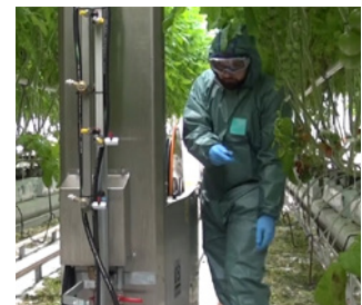
Quando si cambiano gli ugelli è necessario indossare vestiti protettivi per evitare il contatto con il fogliame trattato.
