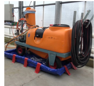
Une station de remplissage-lavage mobile récupère les PPh en cas de déversement.
