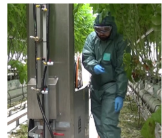
Lors du changement de buse, des vêtements de protection sont nécessaires pour protéger le travailleur lors du contact avec les feuilles traitées.
