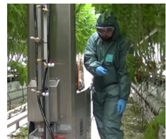
Beim Düsenwechsel ist Schutzkleidung erforderlich wegen des Kontaktes mit gespritzten Blättern.
