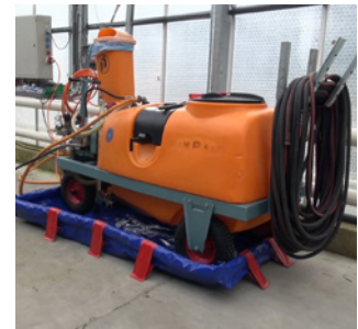
Ein mobiler Wasch- und Befüllplatz fängt verschüttete PSM auf.
