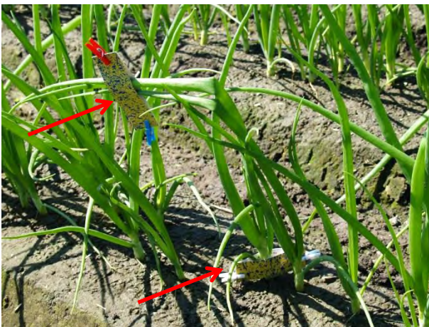
Foto 15: Dropleg montate su una barra di trattamento automotrice di 28 m in una coltura di cipolle. Il semplice controllo della distribuzione della poltiglia con cartine idrosensibili, ha evidenziato come il solo uso dei dropleg permetta una sua omogenea ripartizione su tutta la coltura, sia a uno stadio precoce (23 giugno), sia ad uno più tardivo (14 luglio). Malgrado una forte pressione da peronospora, l'infezione ha potuto essere combattuta con successo. Negli ultimi anni questo risultato non è stato raggiunto in modo soddisfacente con l'uso di barre di trattamento equipaggiate in maniera tradizionale.
