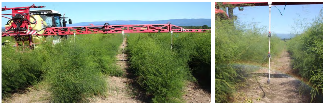
Foto 22: Dropleg impiegati in modo sperimentale in una coltura di asparagi il 18.07.2012: lunghezza del tubo 120 cm, con 3 paia di ugelli del calibro 05; distanza interlinea 1.8 m. volume della poltiglia 1000 l/ha con una pressione di 5 bar e 5 km/h velocità d'avanzamento.
