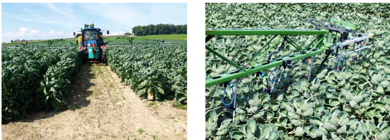
Foto 12: Dropleg con ognuno due ugelli a angolo ampio sotto e al centro del tubo in plastica (confronta anche con foto 6b) sono indicati per colture alte come, p. es., cavolini di Bruxelles (confronta con foto 1). Nello stadio giovanile della coltura, gli ugelli sui dropleg posti più in alto sono chiusi. La deriva è praticamente inesistente poiché gli ugelli dei dropleg sono all'interno della vegetazione.
