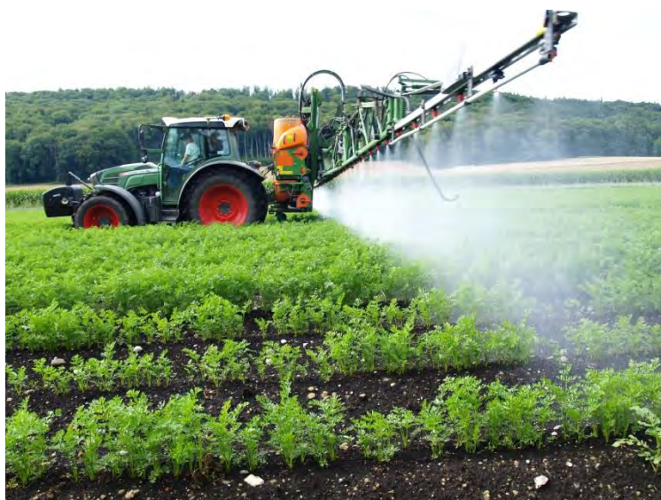
Foto 2: tecnica standard d'applicazione con ugelli ad angolo ampio, che irrorano la coltura (carote) dall'alto verso il basso.
